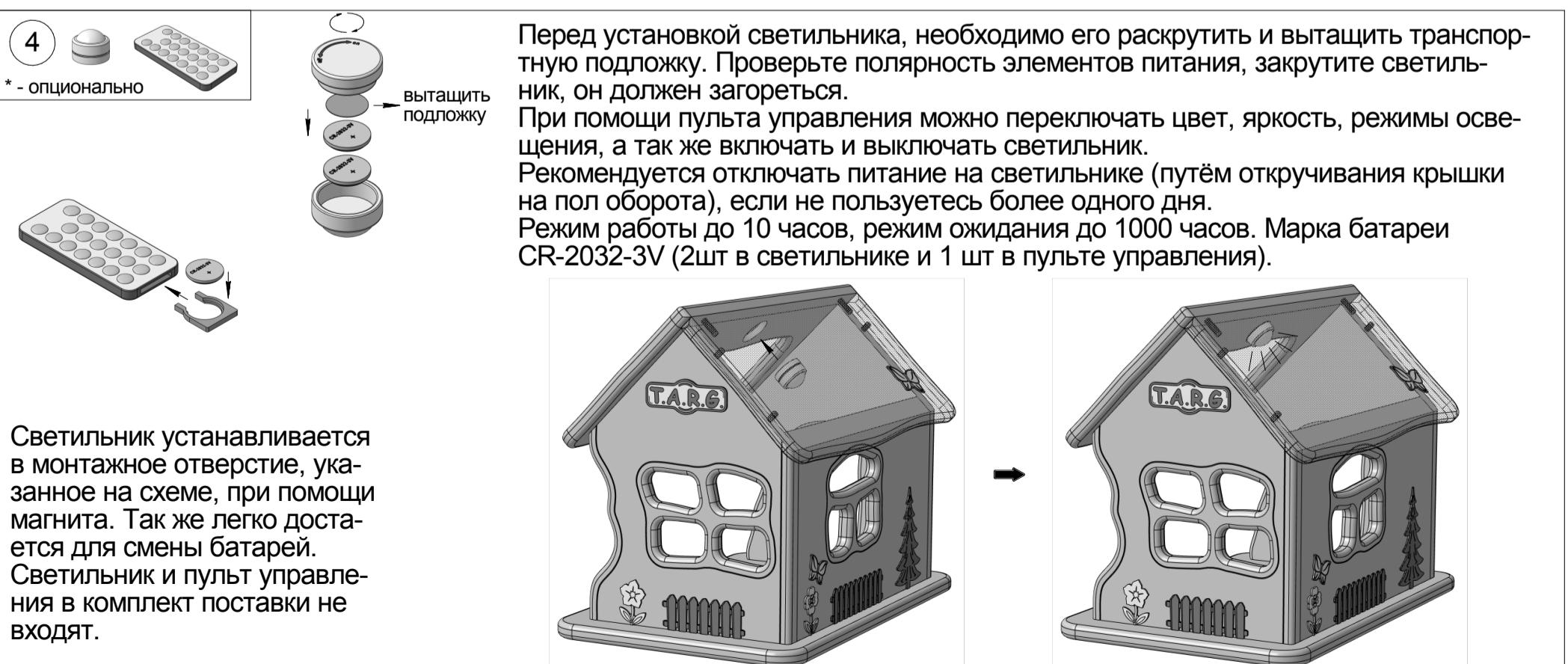
Светильник устанавливается в монтажное отверстие, указанное на схеме, при помощи магнита. Так же легко достается для смены батареи. Светильник и пульт управления в комплект поставки не входят.
