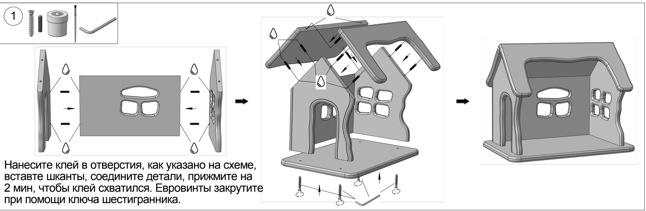
Нанесите клей в отверстия, как указано на схеме, вставте шканты, соедините детали, прижмите на 2 мин, чтобы клей схватился. Евровинты закрутите при помощи ключа шестигранника.
